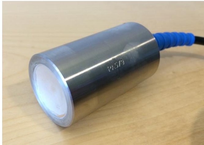
Figur 3 Eksempel på en piezoelektrisk ultralydtransducer. Den hvite ene-flaten vibrerer og genererer ultralyd når transducere drives med en varierende elektrisk spenning.
